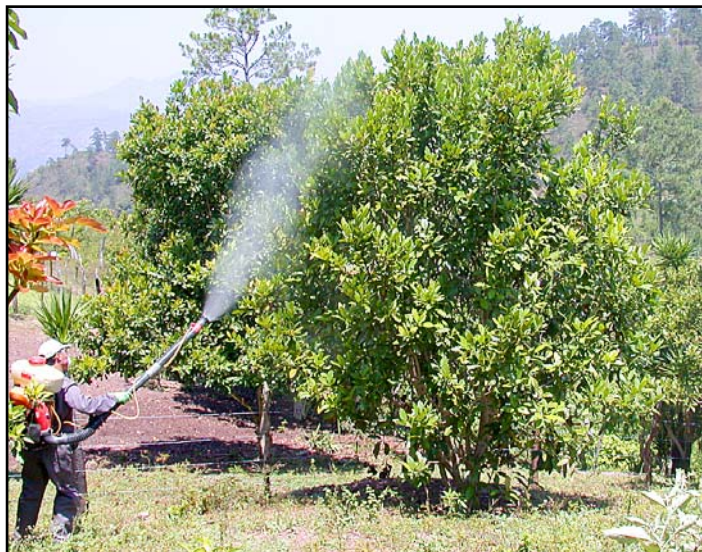
Motoaspersoras con bomba propulsora y cañón alargado.
