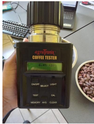
Figura 39 y 40. Medición de humedad del grano de cacao.
