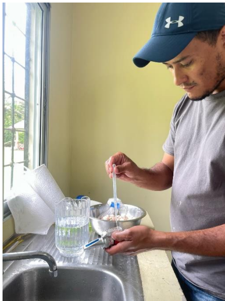
Figura 19 y 20. Limpieza del refractómetro con agua destilada (izquierda) para reiniciar el medidor (derecha).
