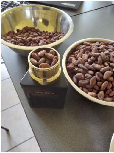
Figura 39 y 40. Medición de humedad del grano de cacao.
