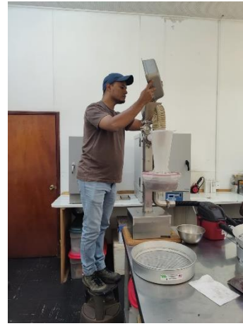
Figura 44. Separando cascarilla y grano en el descascarillador.
