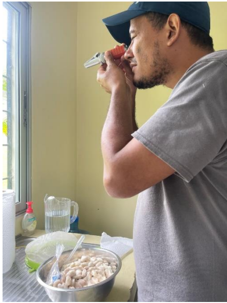
Figura 17 y 18. Medición y lectura de grados brix.
