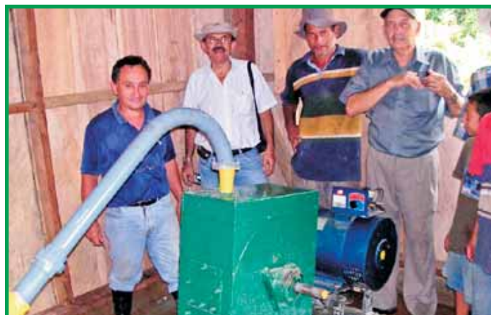
Micro hidro turbina (12.5 kW) instalada en El Recreo, La Masica, Atlántida.
