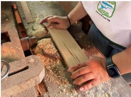
Anexo 25. Ejecución de prueba de escopleado.
