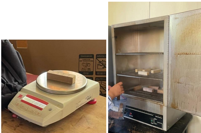
Figura 8. Instrumentos utilizados para la ejecución de las pruebas físicas (balanza digital y horno)
