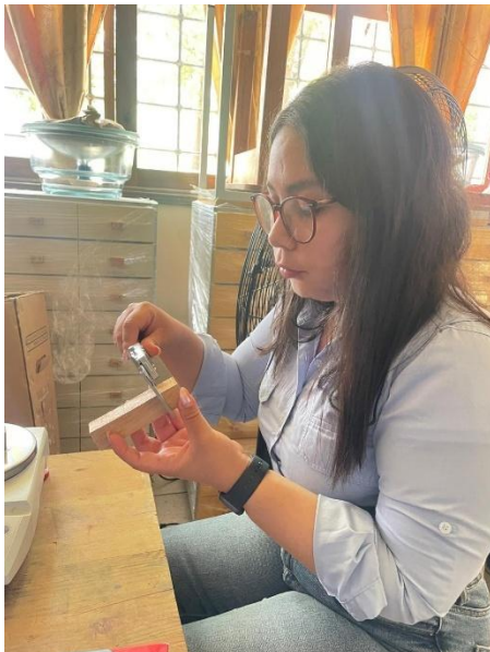
Anexo 16 Marcación y sumersión de probetas para pruebas físicas.
