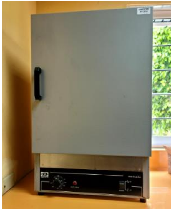
Anexos 8 Horno de laboratorio para pruebas físicas
