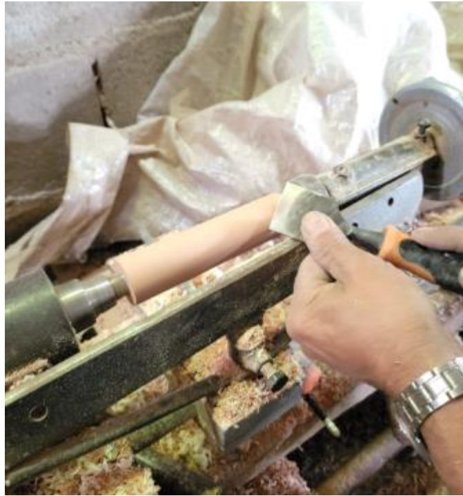
Anexos 14 Prueba de torneado en probetas de cedrillo para caracterización de trabajabilidad
