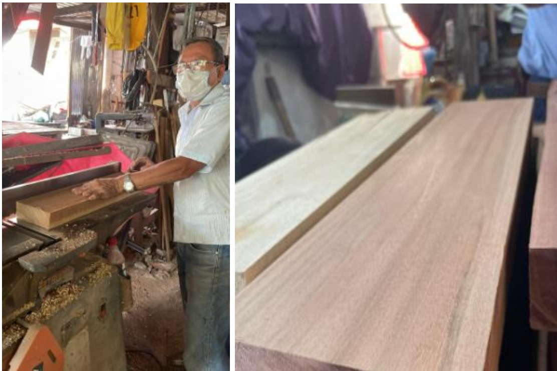
Anexos 13 Prueba de cepillado en probetas de cedrillo para caracterización de trabajabilidad
