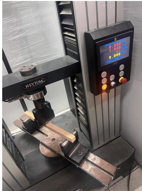
Anexo 11. Probeta sometida a prueba de flexión estática
