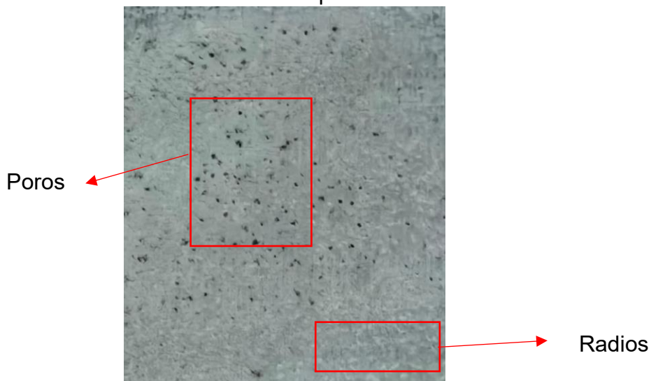
Figura 16. Sección transversal (macro): poros difusos pequeños a medianos, distribución homogénea.
