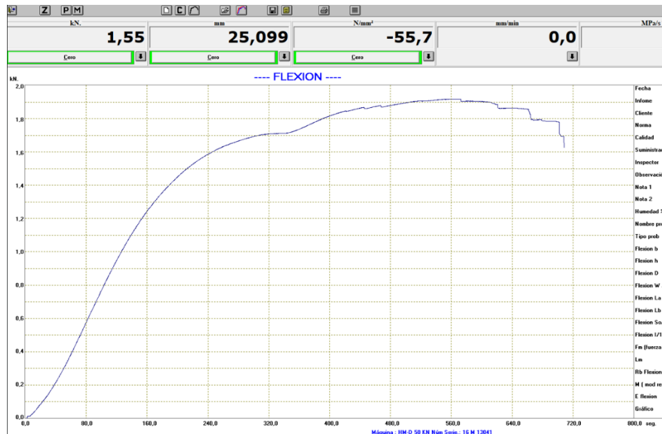
Anexo 12. Gráfica de prueba de flexión estática
