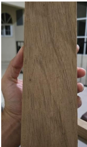
Figura 14. Cara longitudinal de Cordia megalantha : grano mayormente recto, textura fina-media y brillo medio-bajo.
