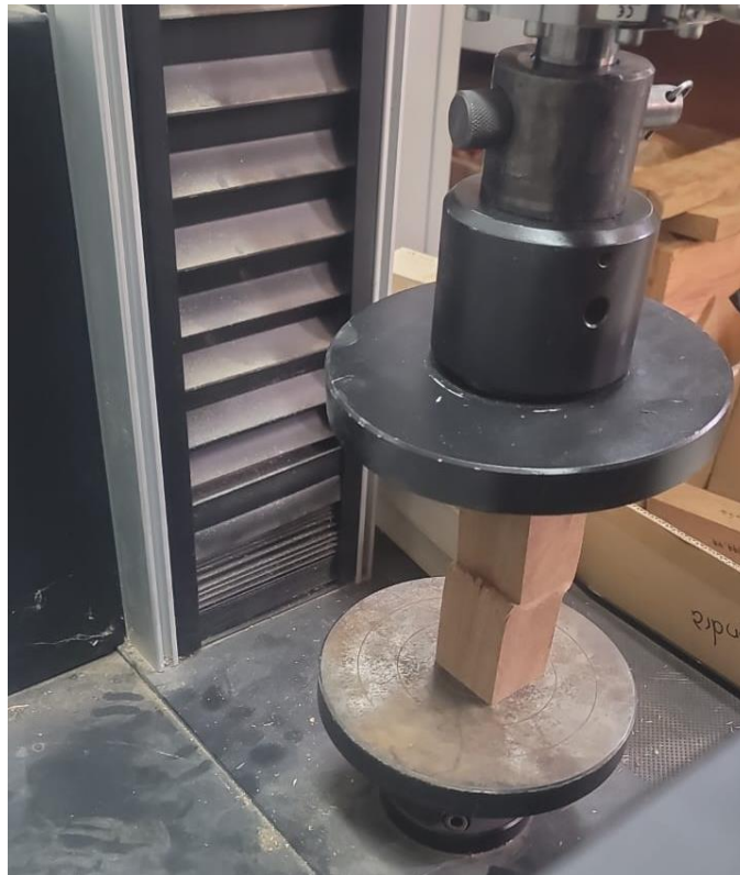
Anexo 14. Probeta sometida a prueba de compresión paralela a las fibras
