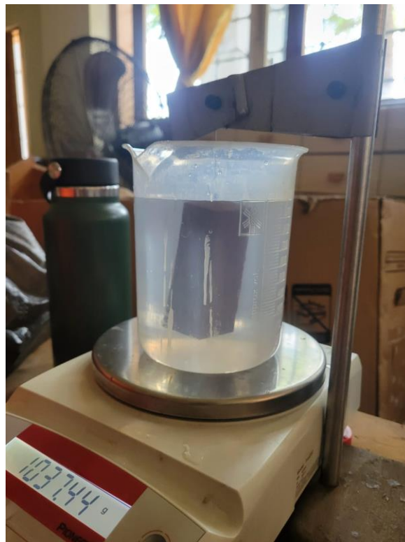
Anexo 8. Determinación del volumen con el principio de Arquímedes
