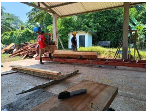
Figura 5: Aserrado de la madera de la especie Guarea grandifolia
