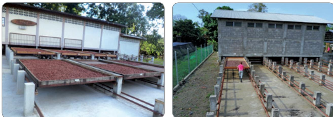
Figura 9. Área de secado natural del grano de cacao en gavetas corredizas tipo Elba.
