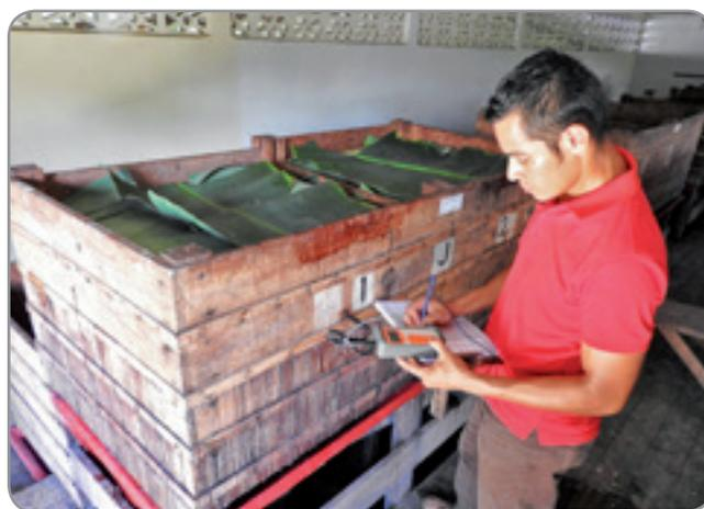
Figura 31. Registro de temperatura de cada cajón de fermentación.
