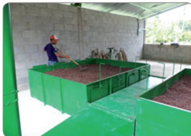
Figura 35. Remoción de granos en secadora artificial.
