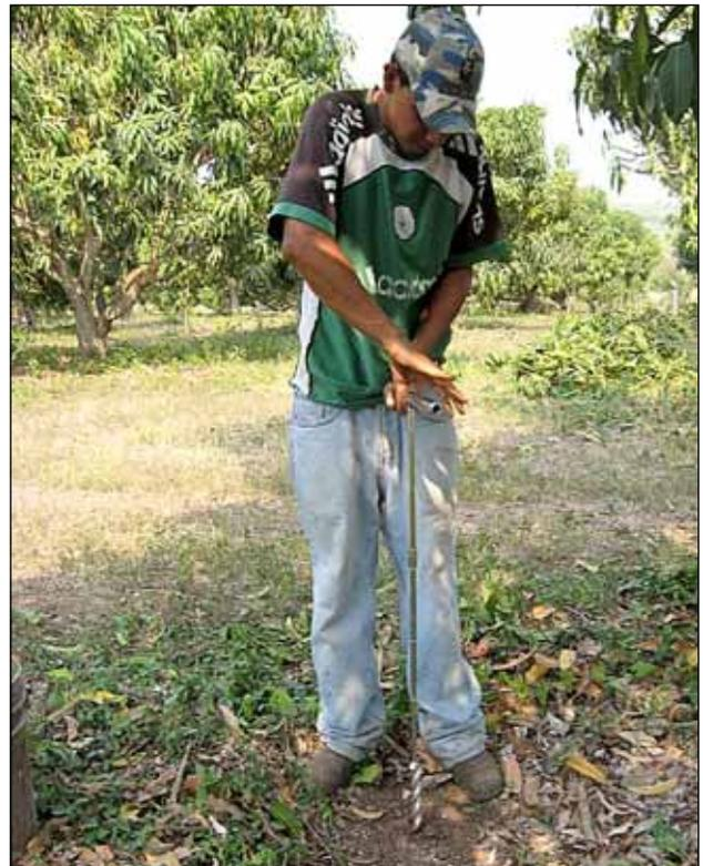
**Tomando sub muestra de suelo utilizando un barreno especial.**
