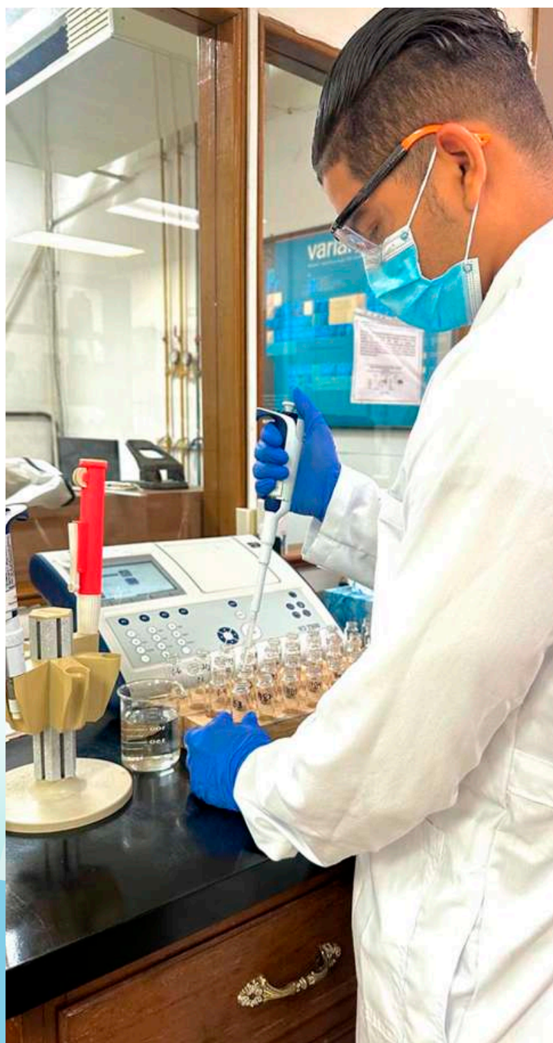
Lectura de Fósforo en Espectrofotómetro UV-Visible (equipo adquirido con los fondos del convenio ACDI/VOCA USAID).
