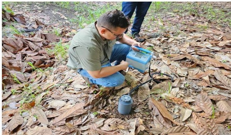
Figura 48. Medición de flujo de CO 2 del suelo con EGM-5.
