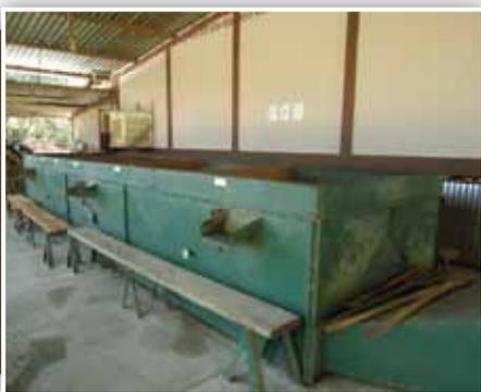
Secado artificial del grano en secador tipo Samoa.
