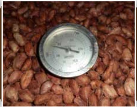
**Tomando la temperatura con termómetro digital con sensor largo insertado dentro del cajón (izq) y con termómetro análogo (der).**
