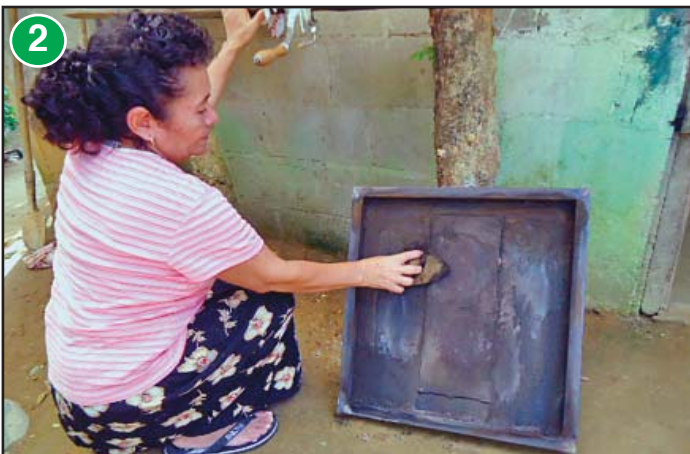
Limpiar la parte interna de la plancha para eliminar el hollín acumulado.
