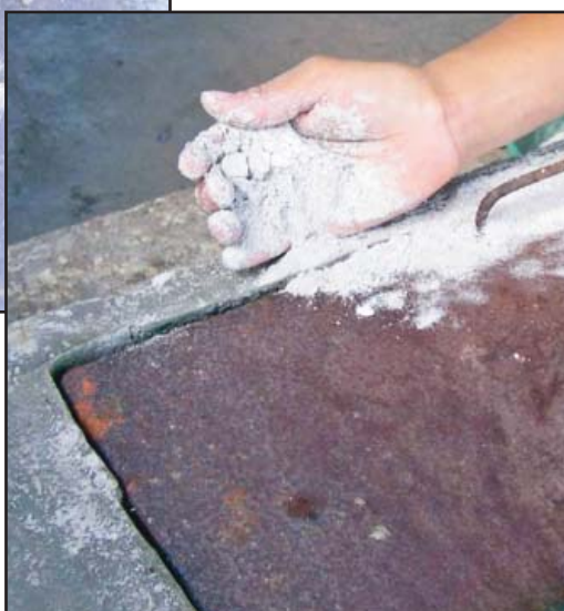
Rellenar con ceniza la ranura en el borde de la plancha para evitar la salida de humo,
