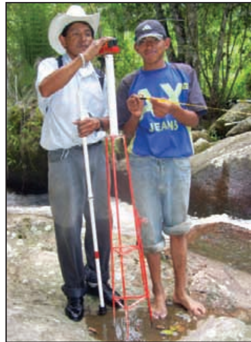
Figura 20. Medición de caída vertical utilizando el nivel Abney.
