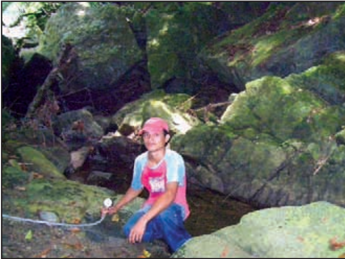
Figura 18. Para obtener la caída vertical con este método, se convierte la presión del manómetro (psi) a metros de columna equivalente.
