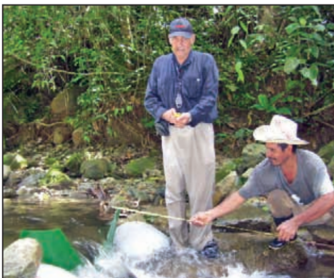
Figura 14. Medición de caudal utilizando un vertedor triangular.
