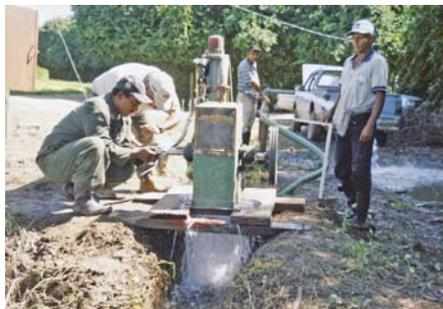
**7** Verificación del funcionamiento de la microhidroturbina en banco de prueba antes de su instalación.
