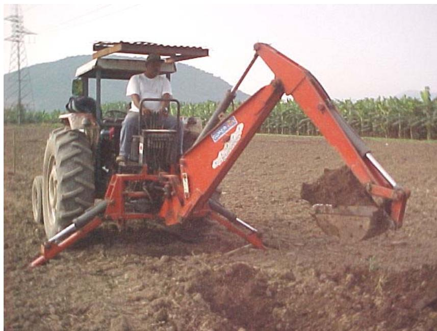
**Una retroexcavadora portátil acoplada a un tractor agrícola facilita la instalación de tuberías principales a óptima profundidad**
