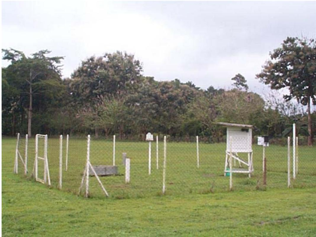
**En la FHIA se utilizan instrumentos esenciales para determinar los cambios atmosféricos a nivel del suelo tales como: anemómetro, higrómetro, piranógrafo y pluviómetro.**
