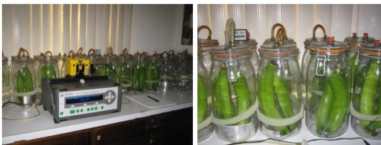
Figura 2. Equipo utilizado para la evaluación de la tasa de respiración de Plátano con tratamientos de RyzUp 40 SG.
