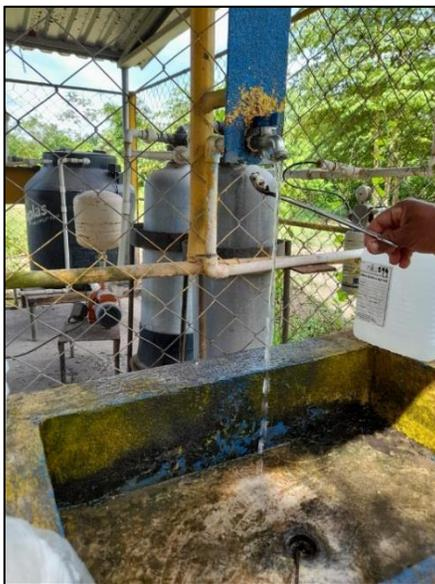
Figura 3. Toma de muestras de agua de pozo.
