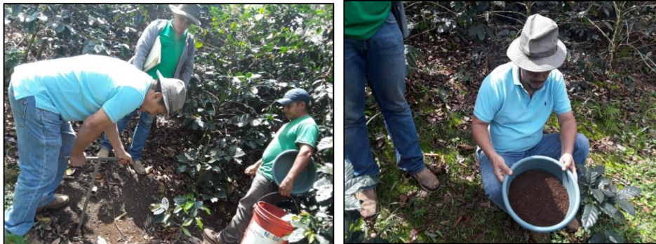
Figura 45. Uso de barreno para extracción y preparación de muestra.
