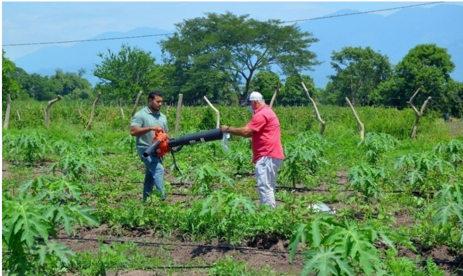
Figura 8. Sopladora-aspiradora de jardín Echo®, modelo ES252, adaptada para aspirar.
