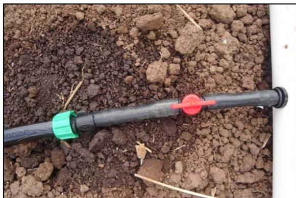
Válvula de cierre de 16 mm utilizada en cada salida de tratamiento.
