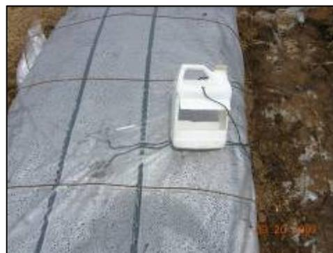
Figura 4. Instalación de sensor electrónico DogWatch para medición de la temperatura a 10 y 20 cm de profundidad.
