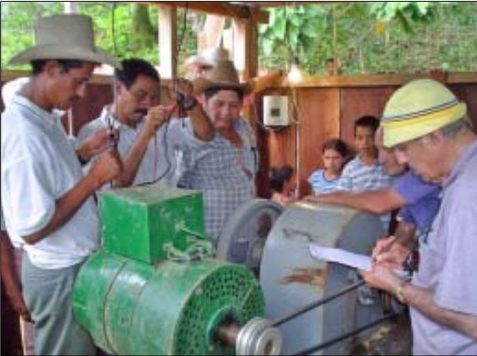
El consultor junto a líderes comunales analizando el funcionamiento de una de las microturbinas.
