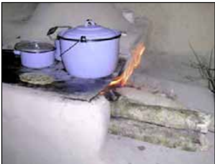
En el fogón tradicional hay una pérdida del calor generado durante la combustión de la leña.
