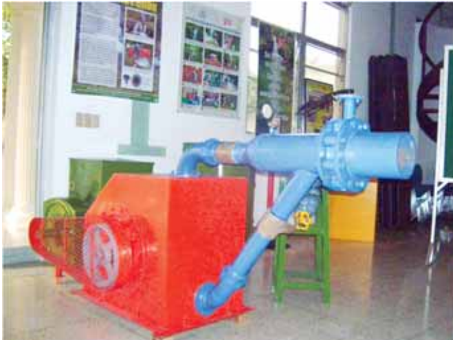
Microhidroturbina Pelton, diseñada en las instalaciones de la FHIA.
