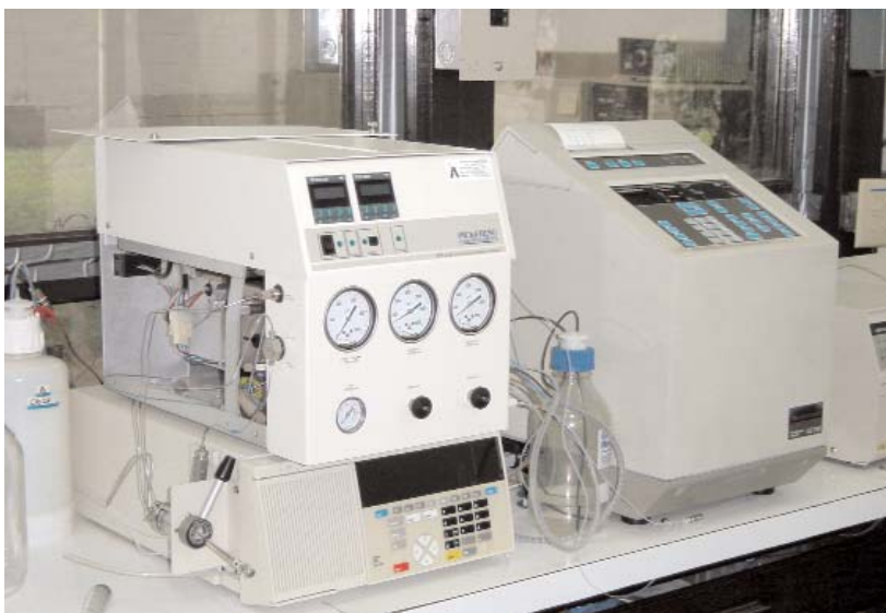
El cromatógrafo líquido es uno de los instrumentos de medición usados por FHIA para el análisis de residuos de plaguicidas en tejidos vegetales y otras muestras.
