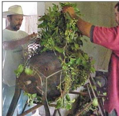
Algunos productores están improvisando máquinas desgranadoras para abaratar costos.
