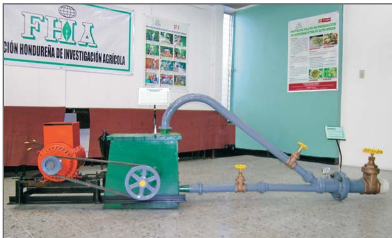
Una micro-hidroturbina de doble boquilla fabricada localmente para impulsar un generador de 7.5 kw, con un caudal de 20 litros por segundo a 50 psi dentro del múltiple.
