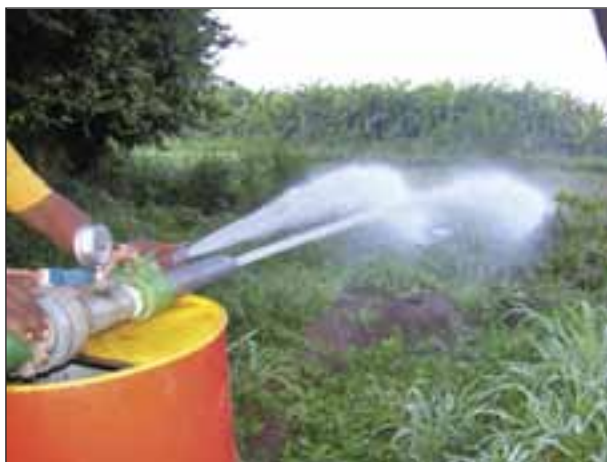
Comprobación de la eficacia de boquillas de diferente diseño. Una vena contracta más reducida impulsa el chorro a mayor velocidad.
