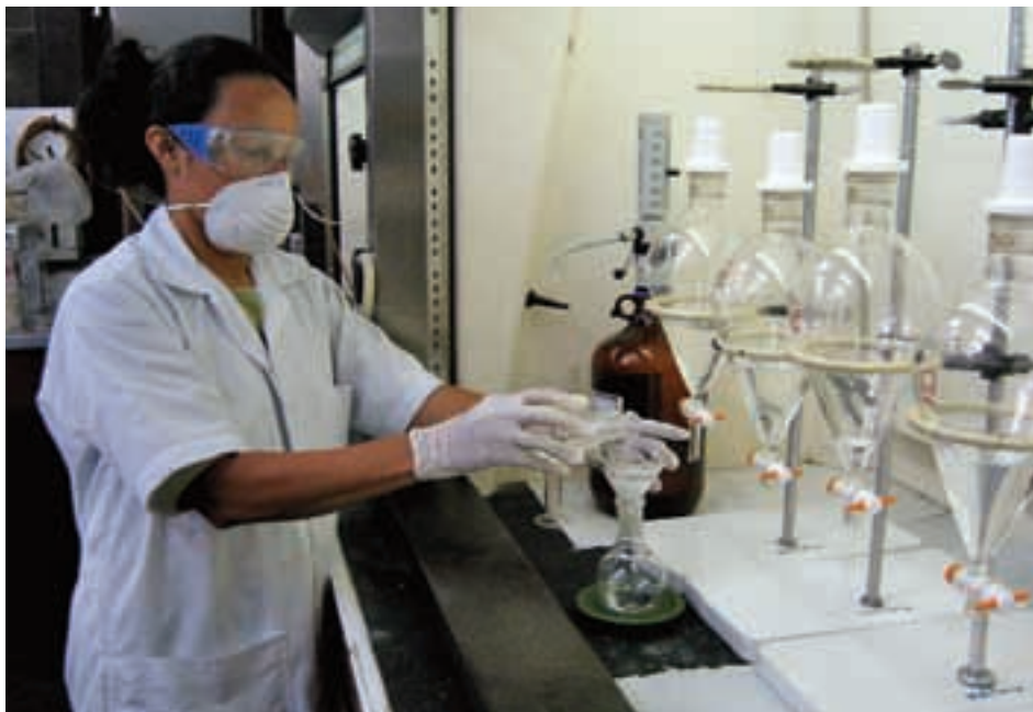
Preparación de muestra de agua para detectar la presencia de productos químicos.
