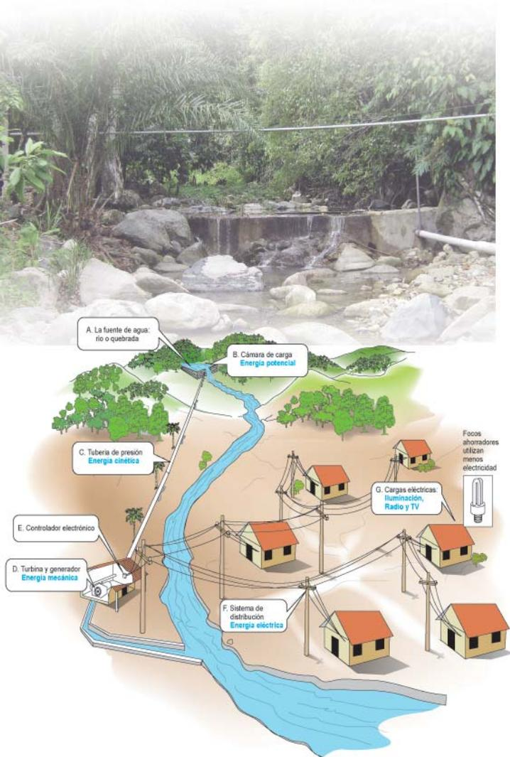
Esquema de funcionamiento de una microhidrocentral.
